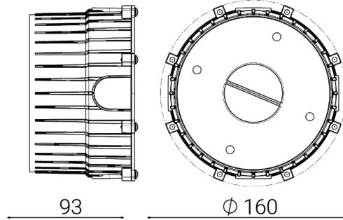
Boîtier pour un encastrement total à ras du mur, fourni avec couvercle
