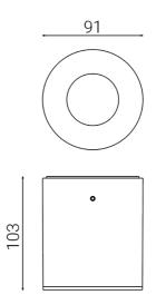
Apparecchio illuminante da esterno per installazione a soffitto Materiale: alluminio pressofuso a basso tenore di rame Diffusore a filo in vetro temprato trasparente ultrawhite Apparecchio fornito senza sorgente luminosa Ingresso cavi dal retro Viti in acciaio inox
