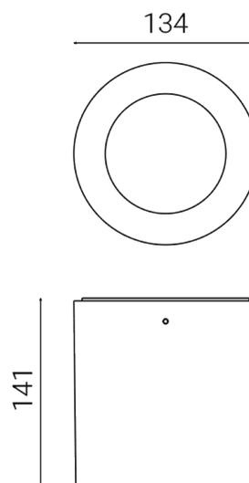
Luminaire d'extérieur pour installation au plafond
