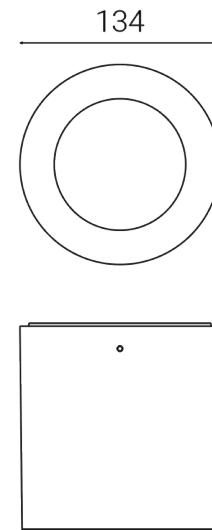
Apparecchio illuminante da esterno per installazione a soffitto
