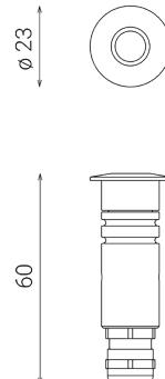
Boden-/Wand-/Deckeneinbauleuchte für den Außenbereich
