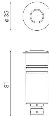
Luminaria de exterior empotrable para instalación en suelo/pared/techo
