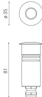
Boden-/Wand-/Deckeneinbauleuchte für den Außenbereich
