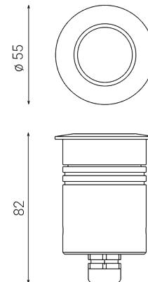
Boden-/Wand-/Deckeneinbauleuchte für den Außenbereich
