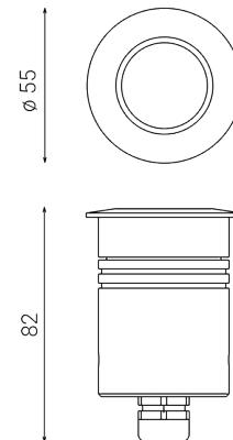
Luminaria de exterior empotrable para instalación en suelo/pared/techo
