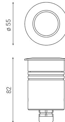
Luminaire encastrable d'extérieur pour installation au sol/mur/plafond
