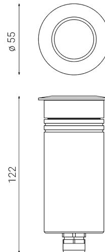
Luminaria de exterior empotrable para instalación en suelo/pared/techo
