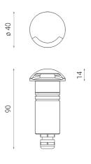
Luminaria de exterior empotrable para instalación en suelo/pared
