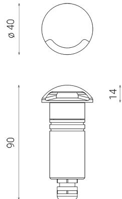
Luminaria de exterior empotrable para instalación en suelo/pared
