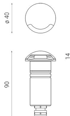
Luminaire encastrable d'extérieur pour installation au sol/au mur
