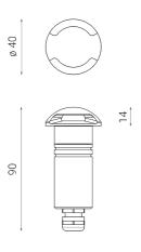
Luminaire encastrable d'extérieur pour installation au sol/au mur
