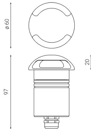
Luminaire encastrable d'extérieur pour installation au sol/au mur
