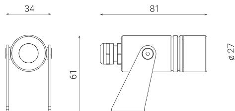
Luminaria tipo spot de exterior para instalación en suelo
