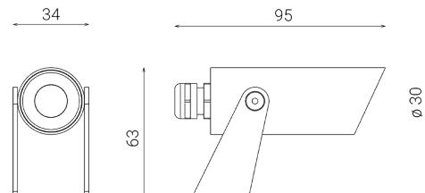
Luminaria tipo spot de exterior para instalación en suelo
