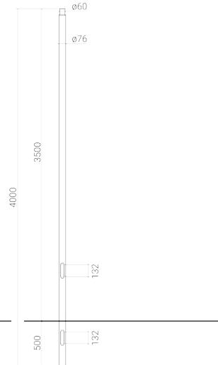
Mast Ø 76 mm aus elektrogeschweißtem Rohr, feuerverzinkt und lackiert / Höhe über Grund 3,50 m + 0,50 m zu vergraben (Gesamthöhe des Mastes = 4,00 m)
