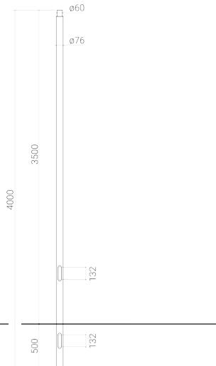
Palo Ø 76 mm ricavato da tubo elettrosaldato, zincato a caldo e verniciato / Altezza fuori terra 3,50 m + 0,50 m da interrare (altezza complessiva del palo = 4,00 m)
