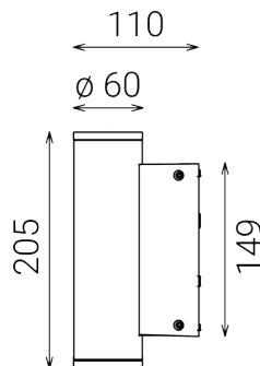
Luminaria de exterior para instalación en pared
