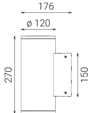
Luminaria de exterior para instalación en pared
