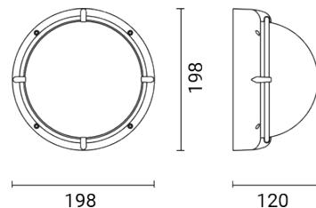
Luminaria de exterior para instalación en pared/techo
