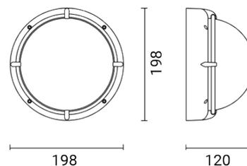
Luminaire d'extérieur pour installation au mur/plafond
