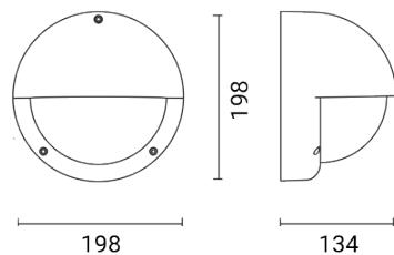
Luminaire d'extérieur pour installation au mur/plafond
