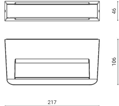
Luminaria de exterior para instalación en pared
